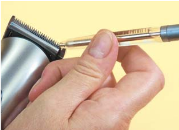
Rys. 2.109. Oliwienie głowicy tnącej w maszynce do strzyżenia włosów
