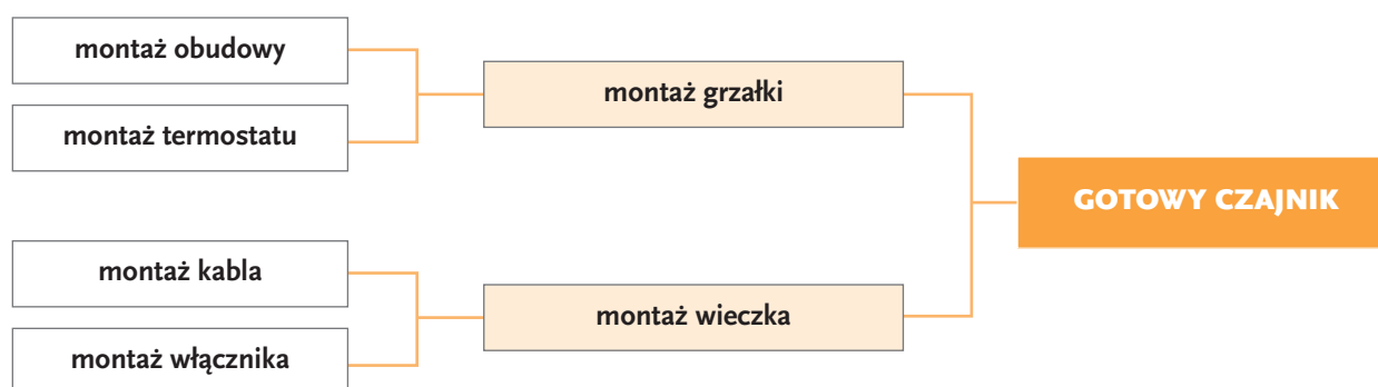
Rys. 10.2. Schemat produkcji czajnika bezprzewodowego
