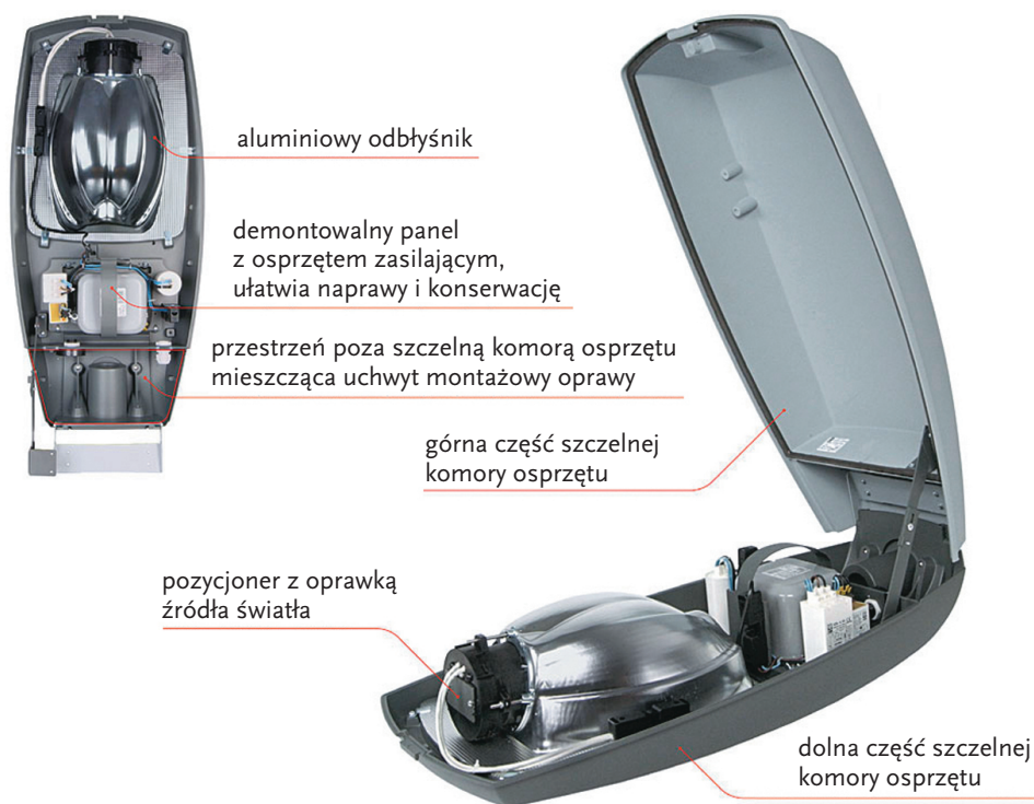
Rys. 5.28. Budowa oprawy zewnętrznej typu Acron 220 (oprawa przeznaczona zależnie od wersji dla lamp sodowych lub metalohalogenowych o mocy do 250 W z trzonkiem E 40)
