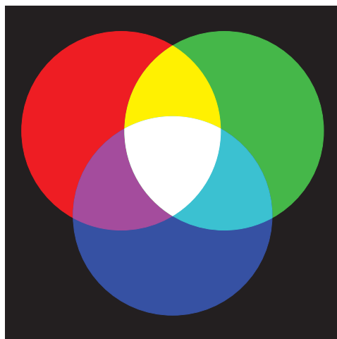
Rys. 5.21. Graficzne przedstawienie metody mieszania barw podstawowych RGB (synteza addytywna) w celu uzyskania innych kolorów – w tym barwy białej
