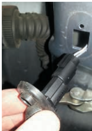
Rys. 12.11. Wybrane czynności podczas demontażu stycznika w drzwiach samochodu: a) odkręcanie śruby mocującej, b) wyjęcie stycznika, c) odłączenie wtyczki instalacji elektrycznej
