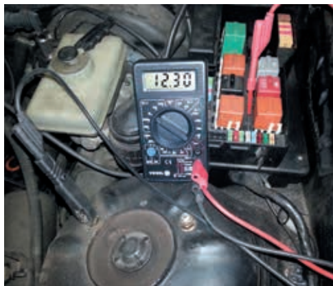
Rys. 2.9. Widok sposobu wykonania pomiaru: a) napięcia zasilania na bezpieczniku, b) napięcia w gnieździe 30 przełącznika
