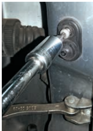
Rys. 12.11. Wybrane czynności podczas demontażu stycznika w drzwiach samochodu: a) odkręcanie śruby mocującej, b) wyjęcie stycznika, c) odłączenie wtyczki instalacji elektrycznej
