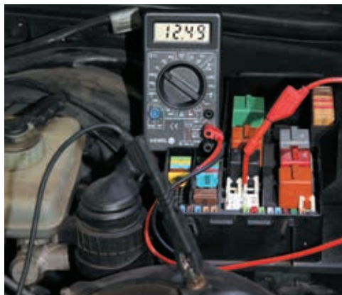
Rys. 2.9. Widok sposobu wykonania pomiaru: a) napięcia zasilania na bezpieczniku, b) napięcia w gnieździe 30 przełącznika
