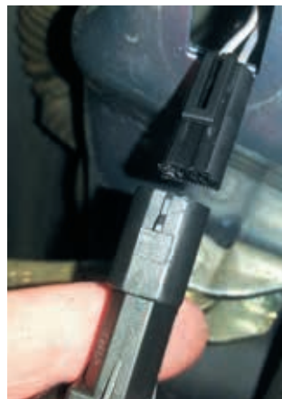
Rys. 12.11. Wybrane czynności podczas demontażu stycznika w drzwiach samochodu: a) odkręcanie śruby mocującej, b) wyjęcie stycznika, c) odłączenie wtyczki instalacji elektrycznej
