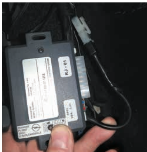
Rys. 12.10. Wybrane czynności wymiany sterownika instalacji alarmowej samochodu: a) odłączenie złączy elektrycznych od sterownika, b) wyjęcie sterownika autoalarmu
