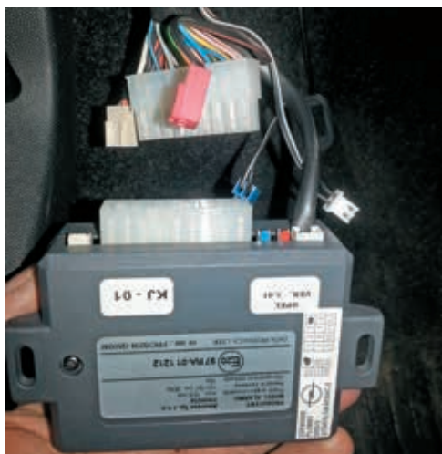
Rys. 12.10. Wybrane czynności wymiany sterownika instalacji alarmowej samochodu: a) odłączenie złączy elektrycznych od sterownika, b) wyjęcie sterownika autoalarmu
