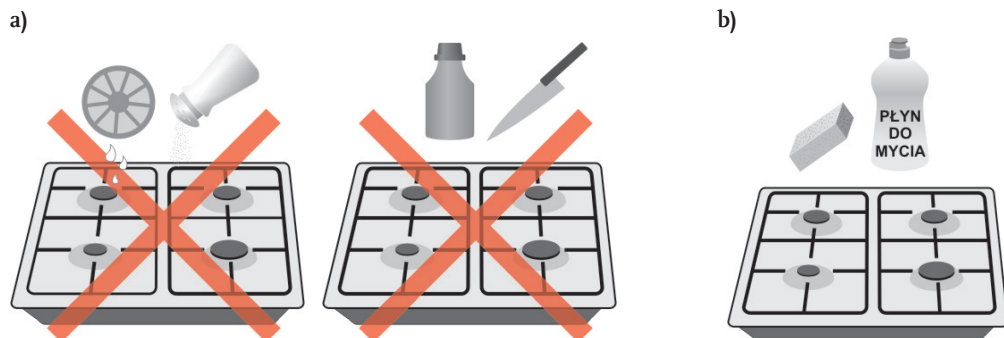
Ryc. 5.6. Konserwacja kuchenki gazowej; a) niewłaściwa, b) właściwa 44
