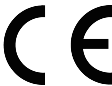
Ryc. 5.4. Wzór graficzny oznaczenia zgodności wyrobów z wymaganiami zawartymi w dyrektywach Unii Europejskiej
