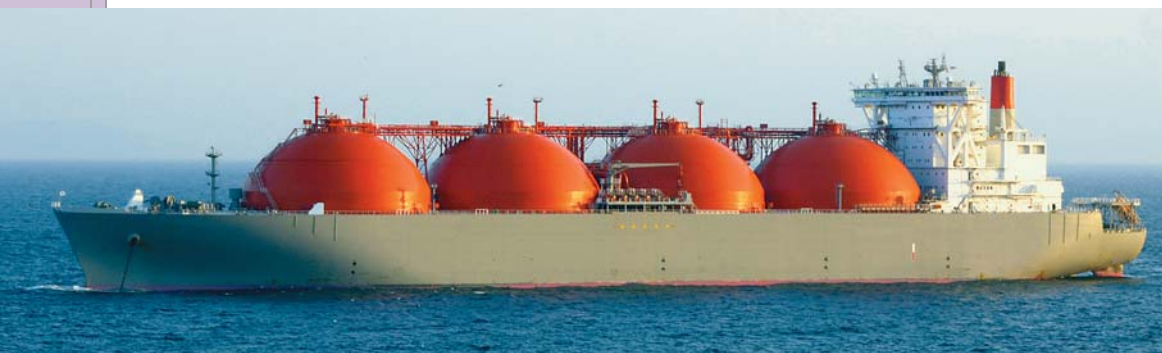
Ryc. 24.6. Znaczną część gazu ziemnego transportuje się w postaci ciekłej specjalnymi gazowcami
